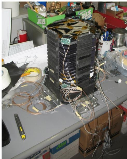
Figura 2.33: Il rivelatore con un fotomoltiplicatore sul primo scintillatore di Trigger.
