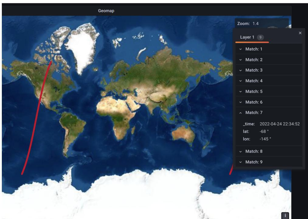
Figura 4.29: Geo Map relativa ad uno specifico dataset richiamata direttamente dalla dashborad «Latest datasets». In rosso il ground track del satellite. Spostandosi con il mouse sul tracciato è possibile vedere il dettaglio dei punti.
